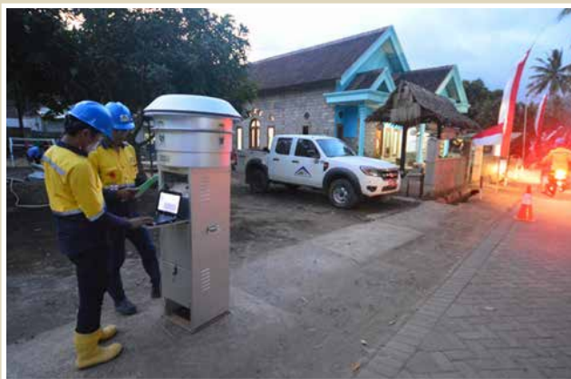
Pemantauan debu dengan menggunakan Pengambil Sampel HiVol dilakukan di desa-desa di Pulau Merah
